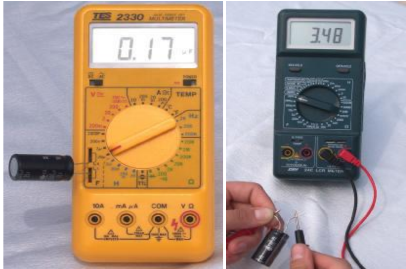
Şekil 2.2: Kapasite ölçümü LCRmetre bağlantısı
