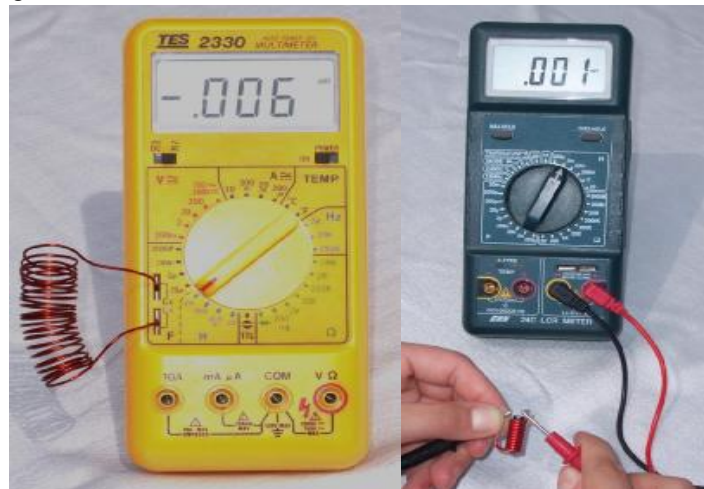
Şekil 2.1: Endüktans ölçümü LCRmetre bağlantısı
