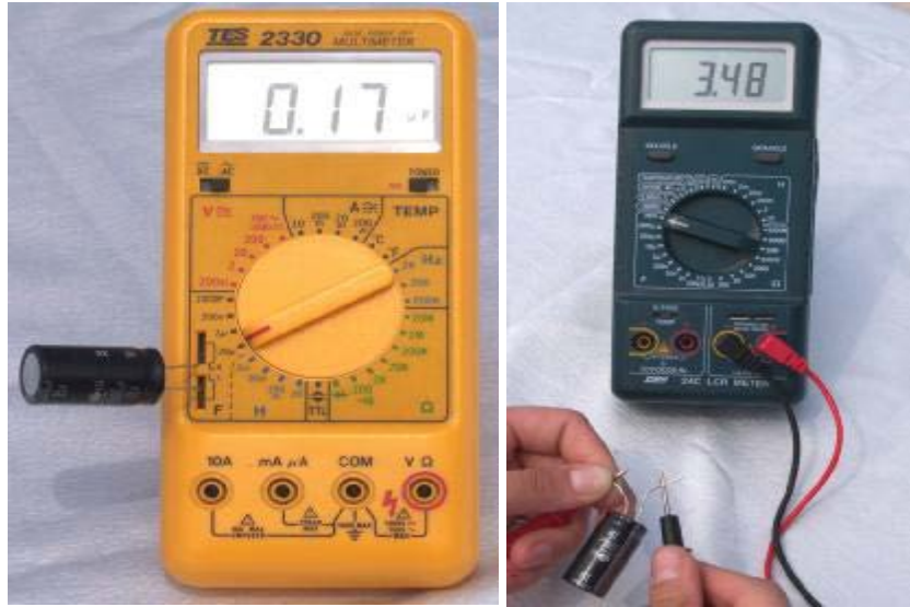
Şekil 7.2: Endüktans ölçümü LCRmetre bağlantısı
