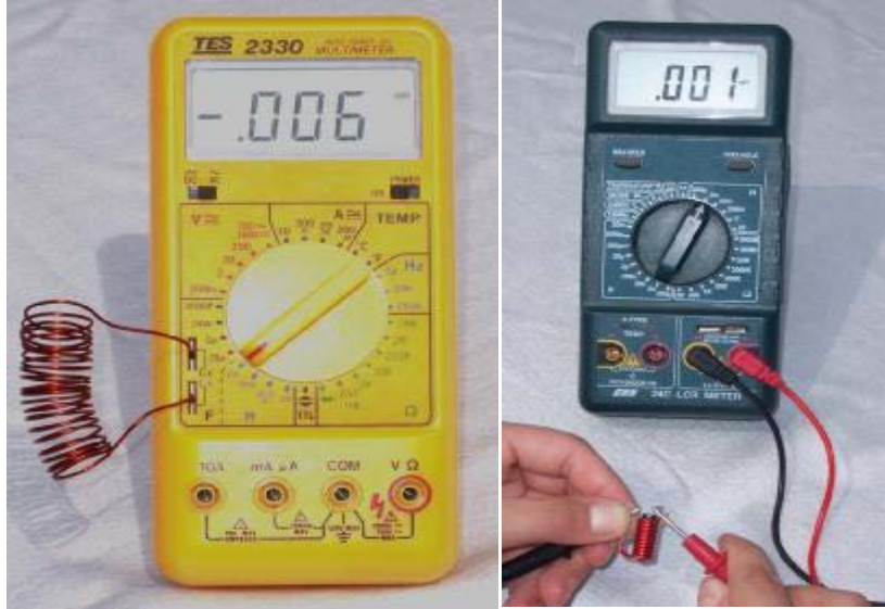
Şekil 7.1: Endüktans ölçümü LCRmetre bağlantısı
