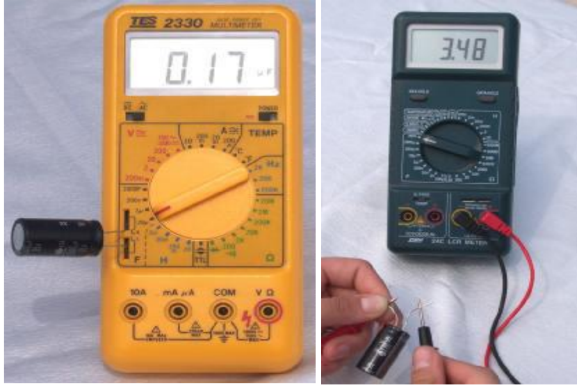
Şekil 7.2: Endüktans ölçümü LCRmetre bağlantısı
